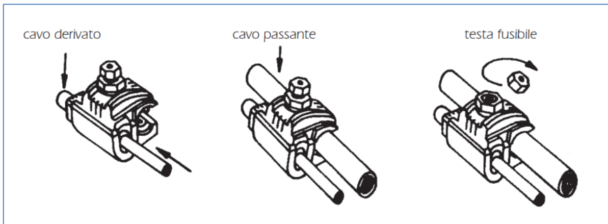
Esempio di utilizzo di morsetto a perforazione di isolante
